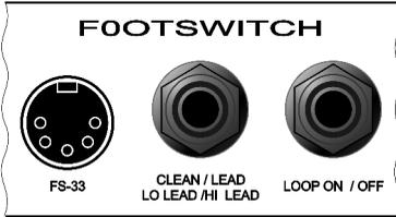
Специальное гнездо для подключения внешнего ножного переключателя FS-33. Левая кнопка CHANNEL осуществляет переключение между CLEAN CHANNEL и LEAD CHANNEL, при включении LEAD CHANNEL загорается светодиод. Центральная кнопка LEAD переключает LEAD CHANNEL в режим HIGH или LOW. При включении HIGH
